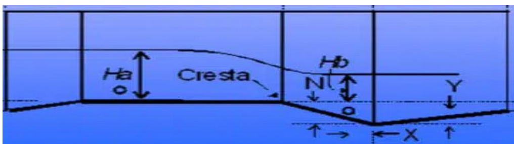
Figura 2 Ubicación de la zona de medición (Canal Parshall, casi cien años midiendo caudales - HidrojING, 2016)
